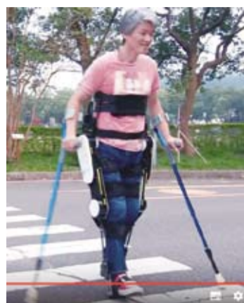
工研院R&D100獲獎技術「行動輔助機器人」是以穿戴式外骨骼機器人設計，透過感測器與動力輔助，讓下半身癱瘓傷友自行穿著的行動輔具。（圖片轉載自工研院網站）
